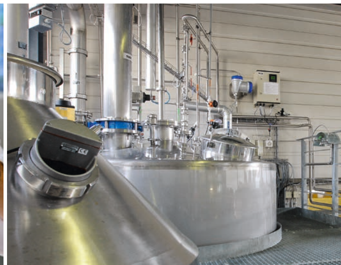
La véritable multiplication de levure se déroule dans l'appareil à fermentation.
