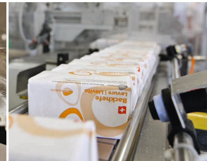
La levure en flocons est compactée, pressée et finalement emballée.
